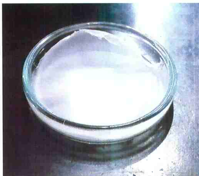
Figura 13 Filme de nanocompósito (PBSL e Montmorilonita) formado na placa de petri após evaporação de clorofórmio
