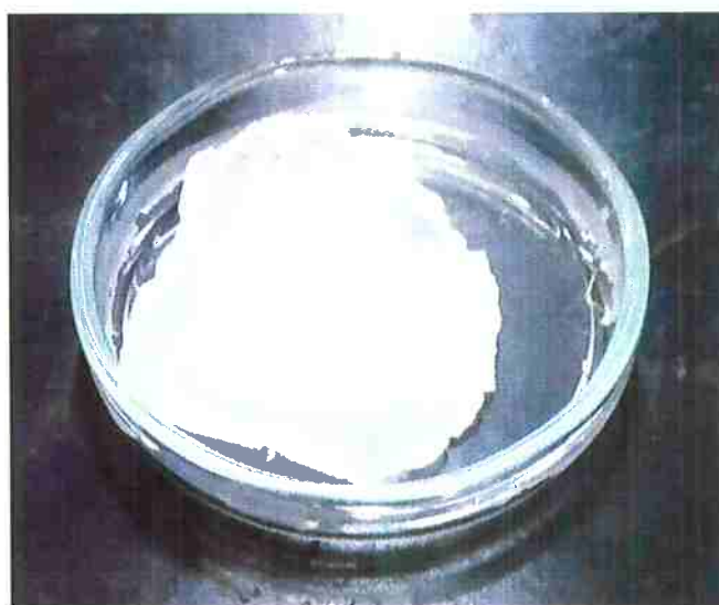
Figura 12 Filme de PBSL formado na placa de petri após evaporação de clorofórmio
